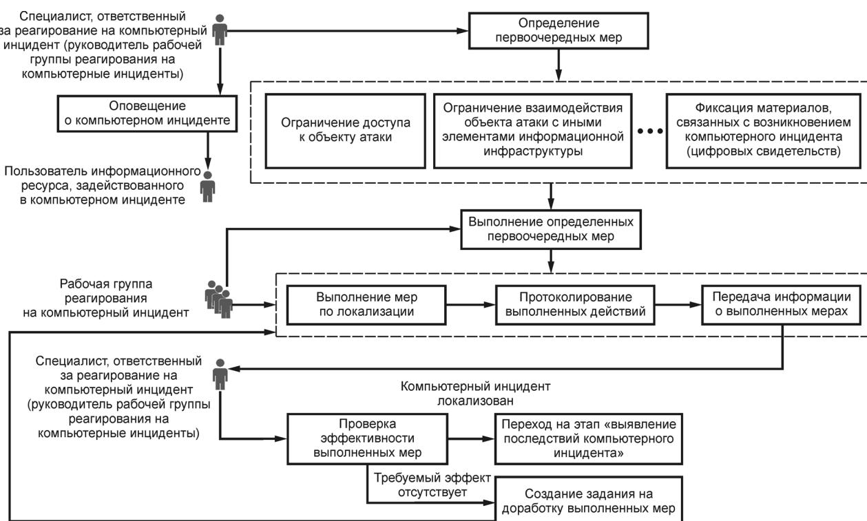
Рисунок 2 — Схема организационного процесса этапа «локализация компьютерного инцидента»
